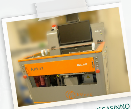
Machine de brasage sélectif SASINNO ANT-1 avec générateur d'azote
